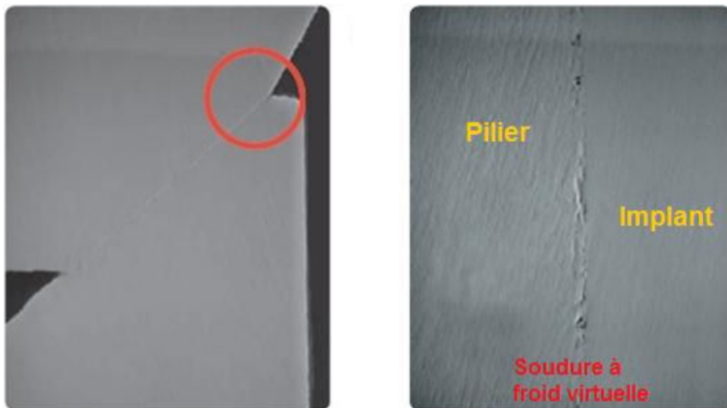
Illustration 42 : coupe connexion hexagone interne à friction zimmerdental (d'après http://www.zimmerdental.com/pdf/lib_catImpSystems4860.pdf ).
