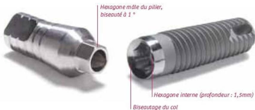
Illustration 40 : système hexagone interne à friction, système tapered screw vent® Zimmerdental (D'après http://www.zimmerdental.com/pdf/lib_catImpSystems4860.pdf ).
