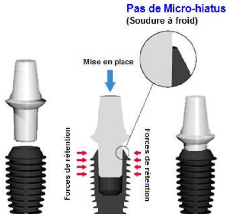
Illustration 15 : forces de rétention sur un implant Bicon. ( httpwww.thaimakeover.comimagesthailand-dental-photobicon-dental-implant-system-thailand.gif )
