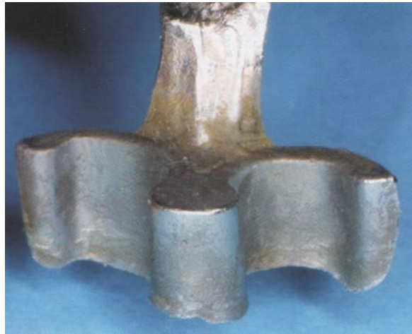
Figure 72 : Forme en « omega » du fraisage principal(8)
