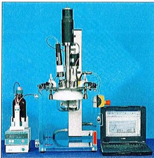
Figure 25: vue de l'installation et schéma du mini-granulateur Mi-Pro (Pro-C-epT, Zelzate, Belgique).
