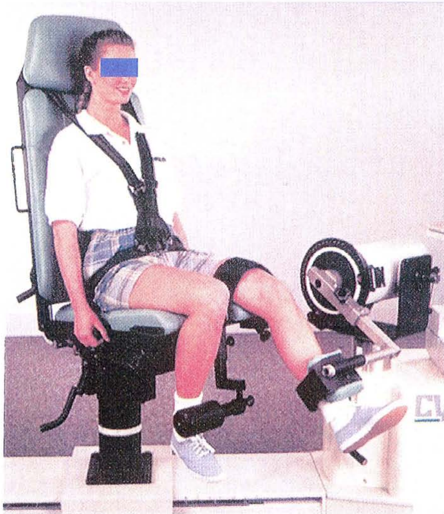
Figure 2 : installation pour l'étude des extenseurs et fléchisseurs du genou sur CYBEX NORM®
