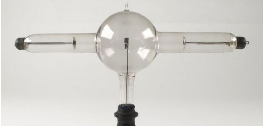
Figure 41 : Tube radiogène double focus (Keller, 1992)
