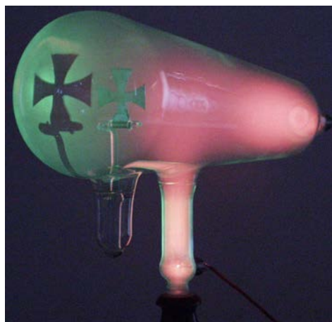
Figure 19 : Le rayonnement cathodique (Keller, 1992)
