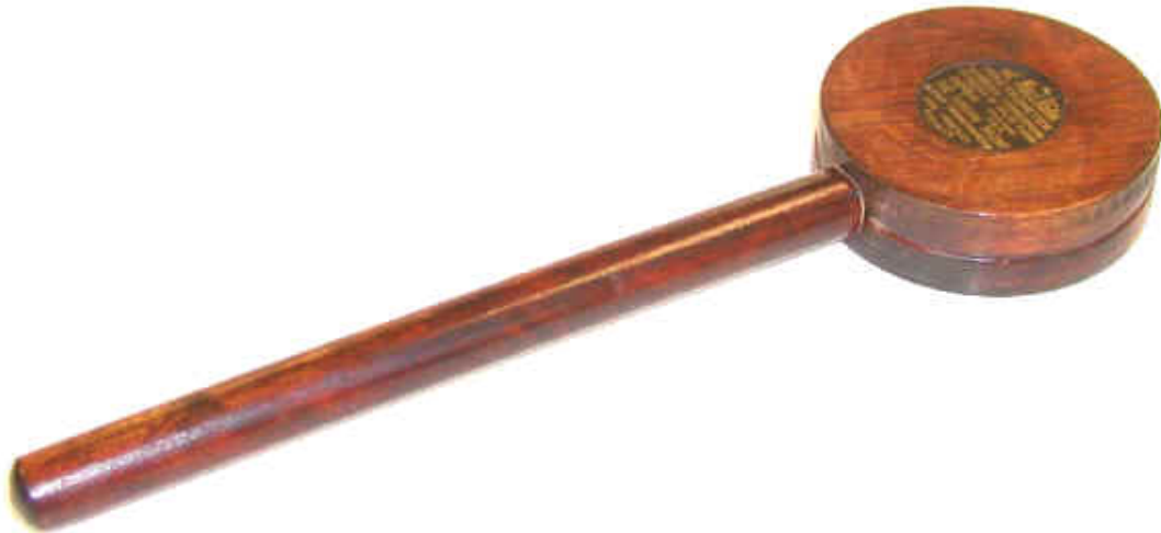
Figure 101 : Le pénétromètre MacLagan (Health Physics, 2012)
