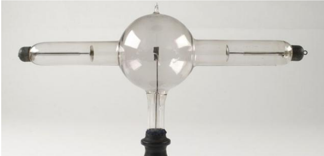
Figure 41 : Tube radiogène double focus (Keller, 1992)
