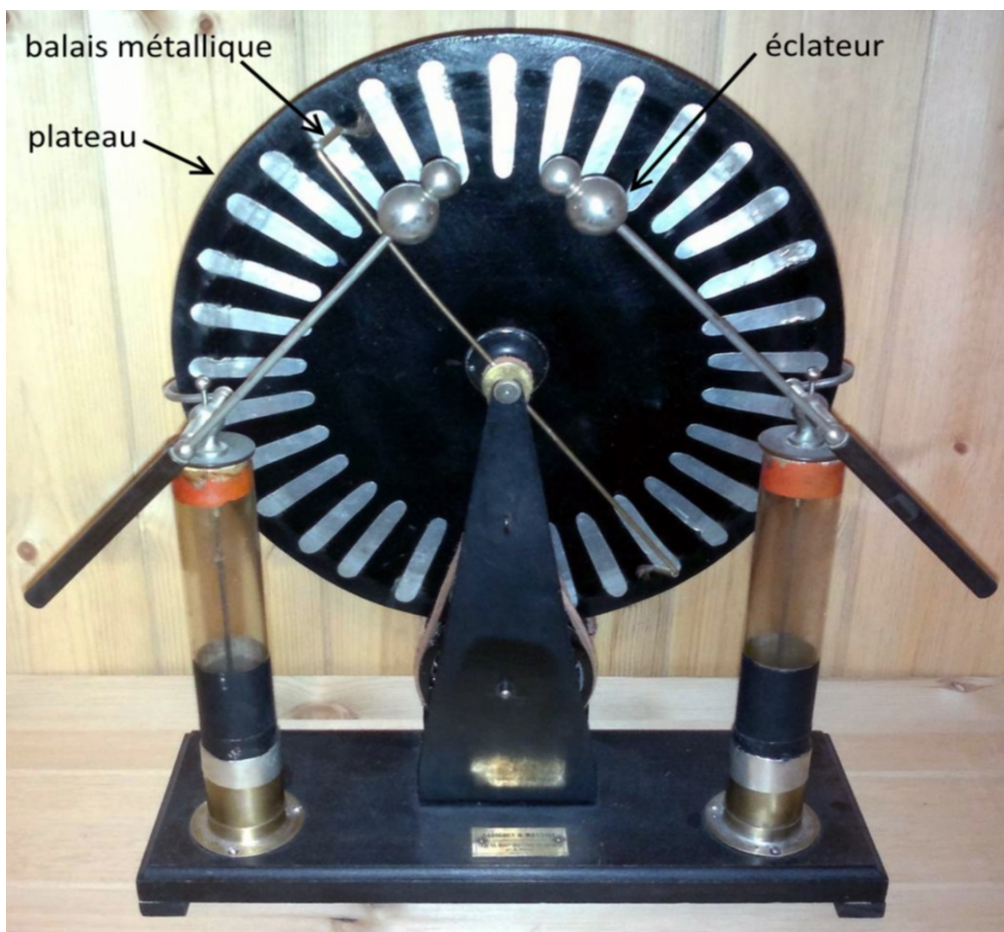
Figure 82 : Machine électrostatique (Keller, 1992)
