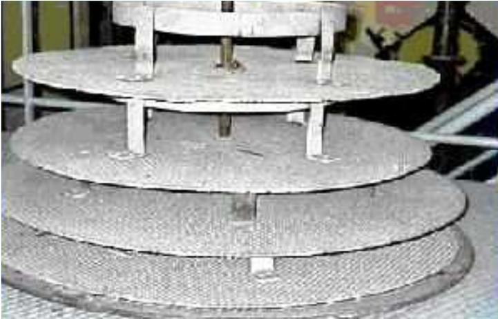
**Figure 8 : Grilles situées dans un extracteur à solvants volatils**
