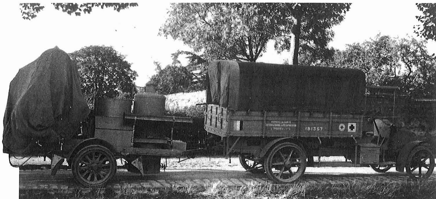
Fig. 42 Camion Renault type EP de la section de lavage et de désintoxication pour ypérités n°1 tractant une remorque avec chaudière et étuve (45).
