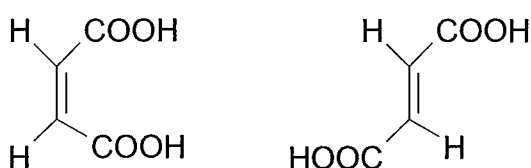
Figure 4. Structure chimique de l'acide maléique (à gauche) et de l'acide fumarique (à droite).
