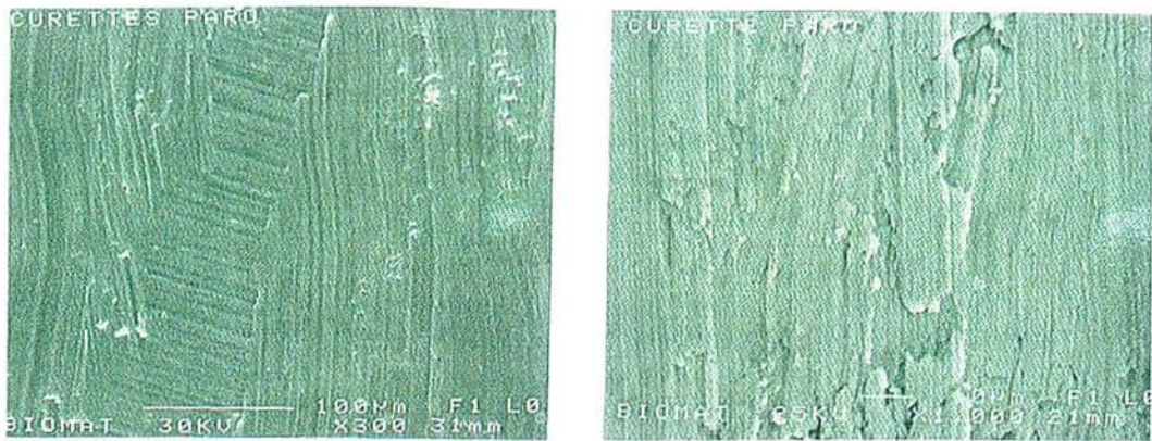
Figure 27- MEB grandissements x300 et x1000. L'état de surface laissé par la curette est très irrégulier, favorisant le dépôt de la plaque bactérienne, d'après Bert [6].
