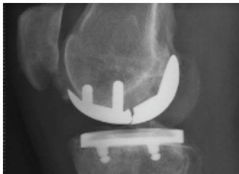
Rupture d'un implant fémoral d'une PUC « métal-back »
