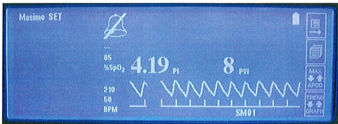
Figure 8 : Exemple d'écran d'oxymètre de pouls affichant les paramètres de photopléthysmographie
