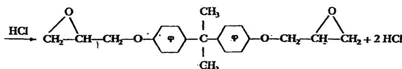
La résine est copolymérisée avec un diacrylate aliphatique qui se greffe sur sa fonction époxy. Le faible poids moléculaire des chaînes aliphatiques assure une bonne qualité de mouillage des parois de la cavité d'obturation.
