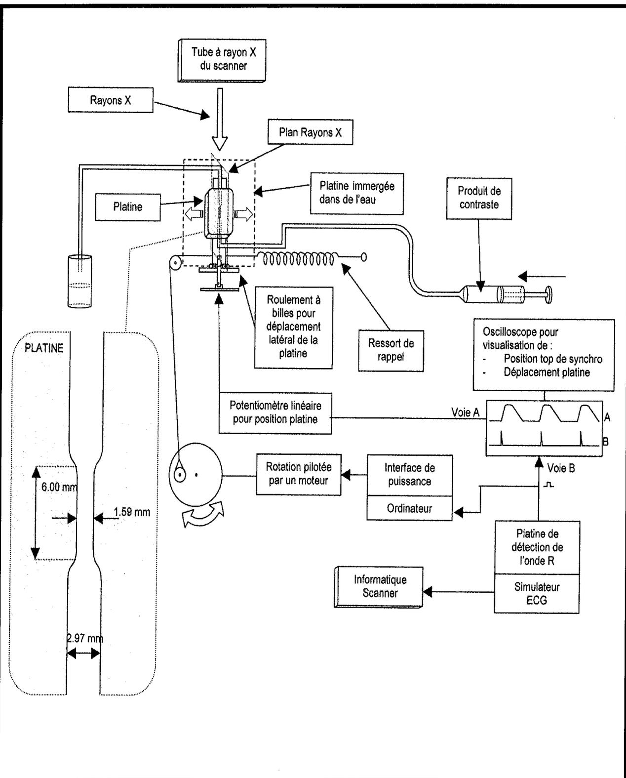
**Fig.2:** Schéma de principe de l'étude du fantôme coronarien.
