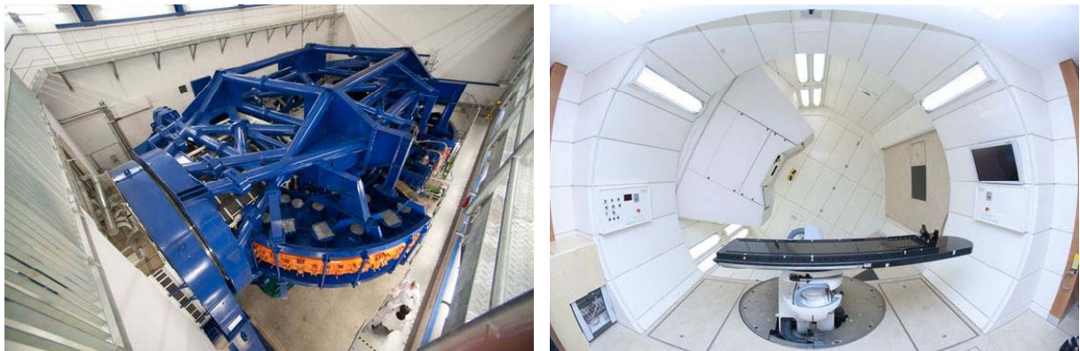
Figure 65 : Le gantry du HIT : à gauche, vue de l'armature ; à droite, vue de la salle de traitement achevée.
