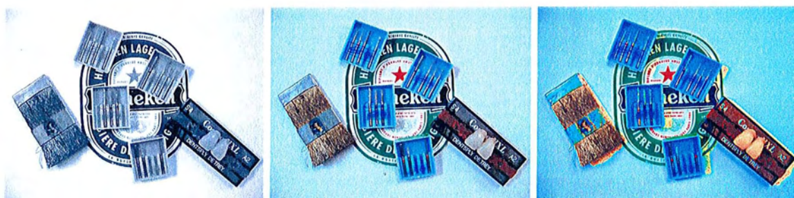
Figure 28 : Réglage de saturation des couleurs : au centre l'image de départ, à gauche l'image avec la saturation à zéro (image désaturée), à droite l'image avec la saturation au maximum.
