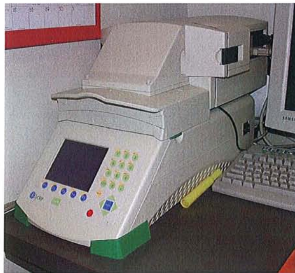
Figure 12 : Un outil de PCR en temps réel : l'appareil ICYCLER de Bio-rad
