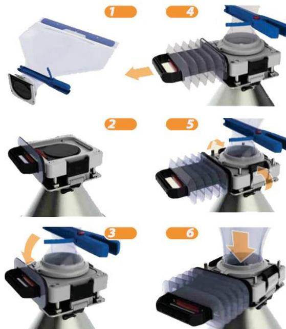
**Figure 16 : Schéma de fonctionnement du système EZI-FLOW, d'après CONTAINED TECHNOLOGIES, [40]**
