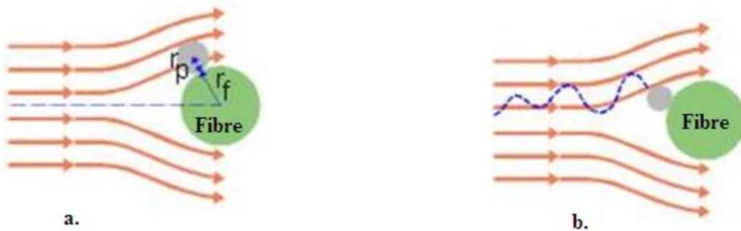
**Figure 37 : Fonctionnement de la filtration : l'interception (a.) et la diffusion (b.), adaptée d'après Energie+, [61]**
