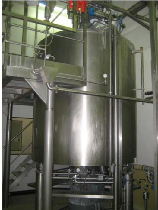
**Figure 25 : Cuve de fabrication de la pommade P.**
