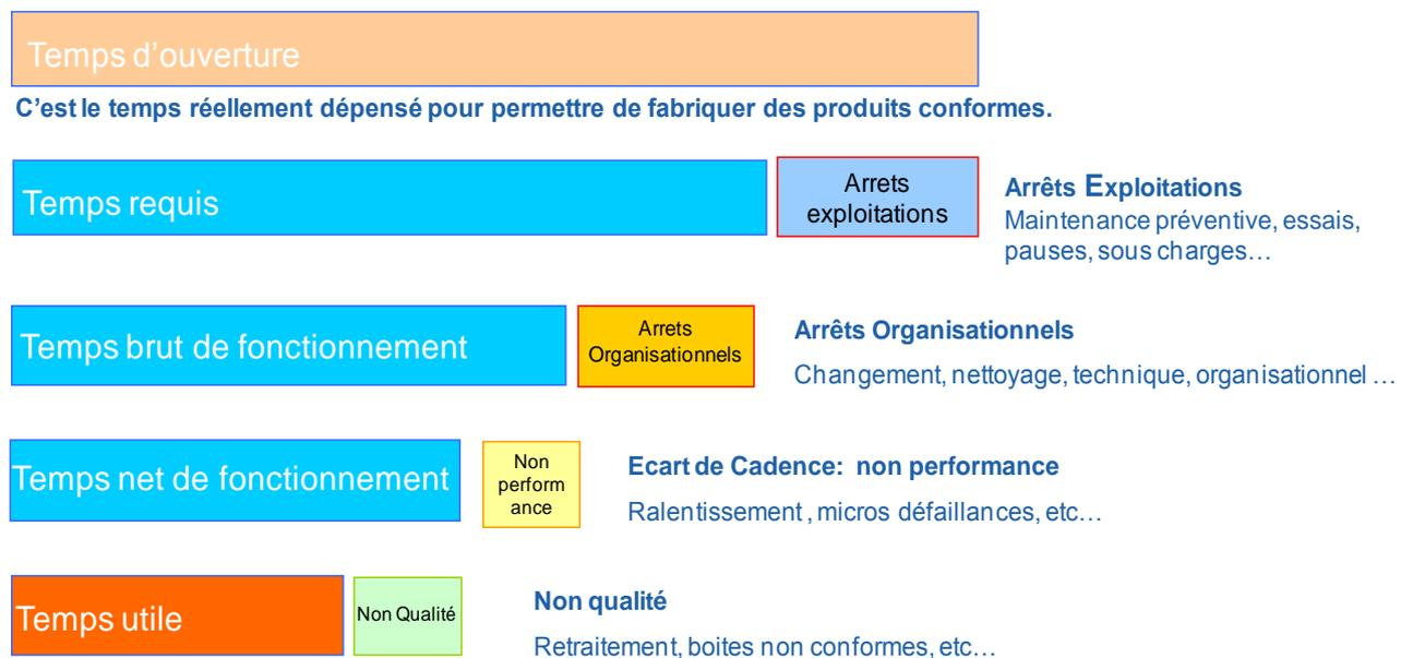
**Figure 15 : Schéma explicatif de la mesure du TRS.**
