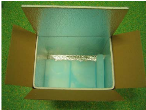
Figure 17 : Le carton de transport avec les 3 blocs réfrigérants
