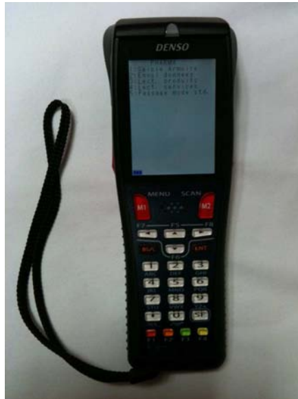
Figure 12 : Douchette utilisée pour la lecture des codes-barres des étiquettes du système Plein-Vide
