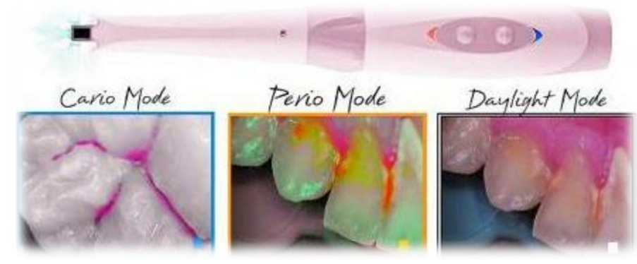
Figure 26 : la caméra endobuccale Soprocare et ses 3 modes de vision
