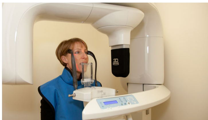
Figure 57 : un appareil hybride (CBCT-Panoramique)
