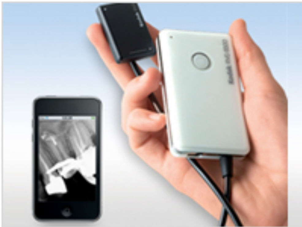
Figure 19 : le capteur RVG 6500 de Kodak peut transmettre la radiographie à un smartphone
