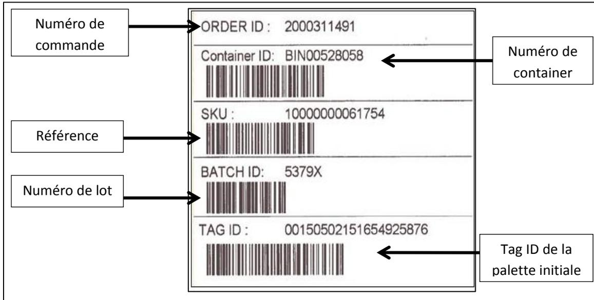
Figure 45 : Exemple d'étiquette de prélèvement de commande
