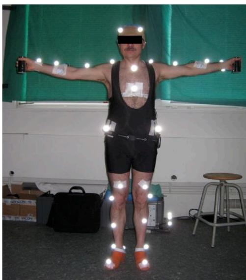
Figure 10 : Epreuve de contraction maximale volontaire des Trapezius (CMV). Le chirurgien lève les bras à l'horizontale en portant un poids de 1 kg dans chaque main, permettant d'activer au maximum les muscles Trapezius.
