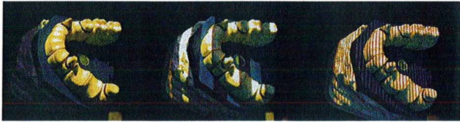
Figure 63 - Scannage du modèle : balayage de bandes blanches et noires de différentes tailles sur le modèle, d'après GOUPIL et GRYNFAS (39)
