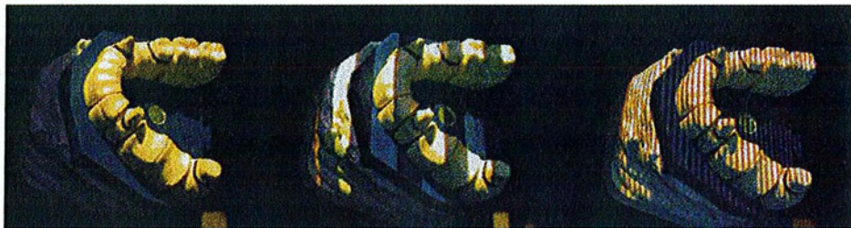
Figure 80 - Scannage du modèle : balayage de bandes blanches et noires de différentes tailles sur le modèle, d'après GOUPIL et GRYNFAS (39)
