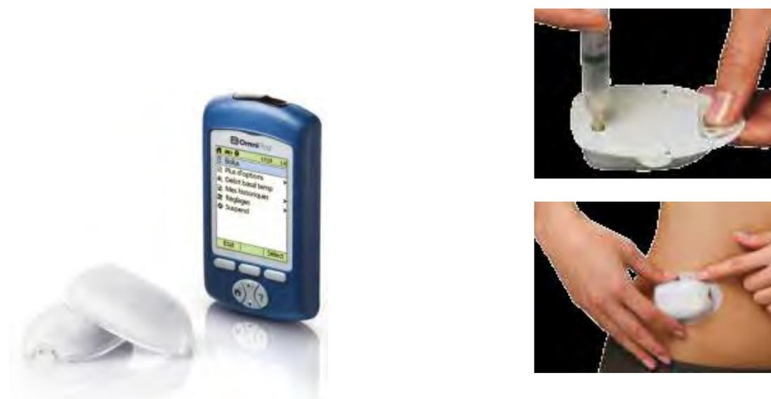
Figure 10: Pompe Omnipod® composé du Pod et du PDM.
