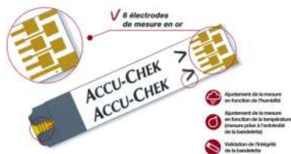
Figure 7 : Schéma d'une bandelette réactive.
