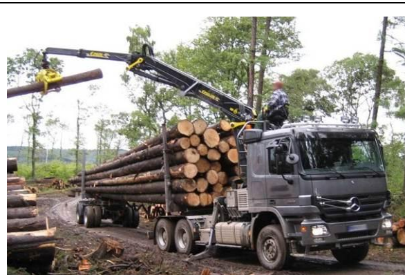
Images 24 et 25 : Chargement (à gauche) et transport (à droite) des grumes sur grumier (Photographies : CCMSA)
