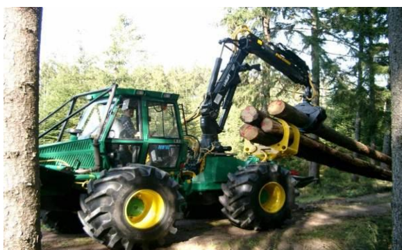
Images 14 et 15 : Débardage mécanique terrestre par débusqueuse (à gauche), et par porteur (à droite) (Photographies : CCMSA)
