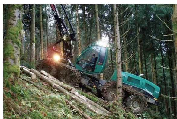
Images 22 et 23 : Abattage mécanisé en zone de pente (à gauche) et tête d'abattage (à droite) (Photographies : P. Magaud (FCBA) à gauche ; AFOCEL à droite)
