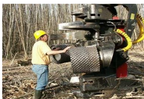
Images 22 et 23 : Abattage mécanisé en zone de pente (à gauche) et tête d'abattage (à droite) (Photographies : P. Magaud (FCBA) à gauche ; AFOCEL à droite)
