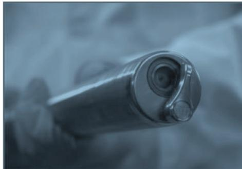
Figure 13 : Détail du dispositif de désencrassement d'une sonde FBRM<sup>®</sup>.
