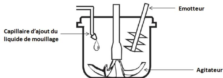
Figure 19 : Schéma type d'un *high shear mixer*.
