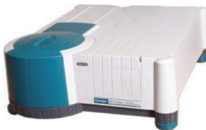
**Figure 33 : Spectrophotomètre d'absorption UV-Visible, Cary 50, Varian.**
