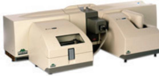
**Figure 32 : Granulomètre laser Mastersizer 2000, Malvern Instrument en configuration voie sèche.**
