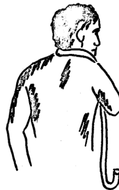
Figure 74 : Canne prenant appui sur l'épaule et la nuque permettant de soulever des charges lourdes.
