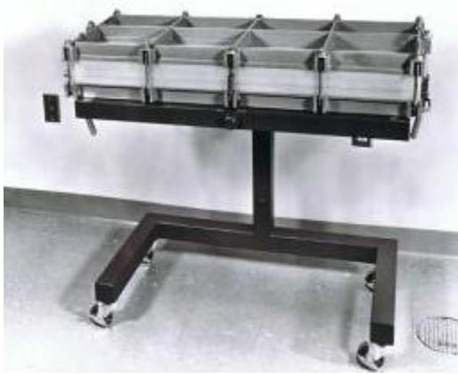
**Figure 21 : Dialyseur à plaques de Kiil [58]**
