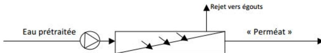
**Figure 61** : Principe de l'osmose inverse : une pompe permet le passage de solutés du compartiment le moins concentré au plus concentré. [26]
