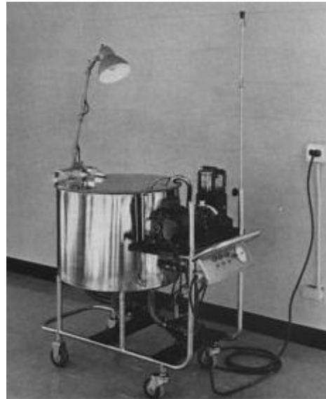
**Figure 19 : Le système de dialyse Twin Coil [36]**
