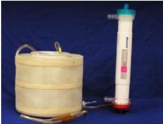
**Figure 56 :** Dialyseur à bobine de Kolff : le Travenol U200A (membrane en cellulose) et un dialyseur moderne à fibres creuses (membrane en copolymère de polysulfone): Xenium 190 de BAXTER [58] [118]
