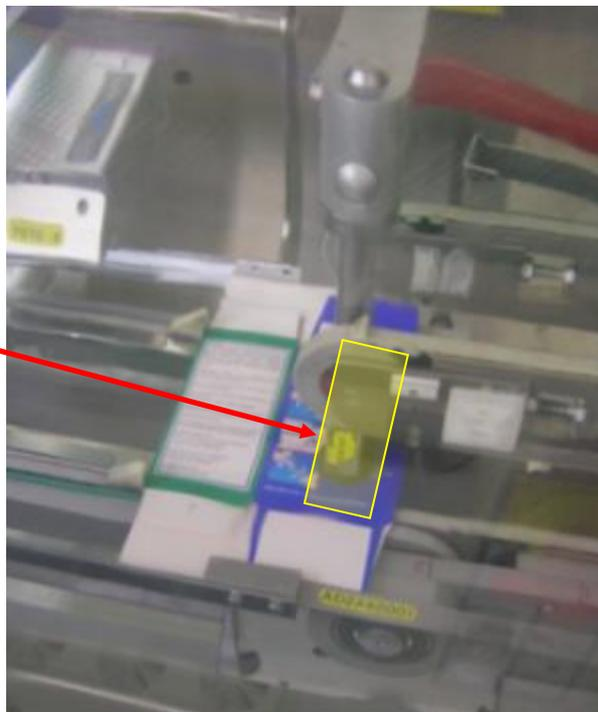
Le repère CA est relié à une transmission mécanique qui permet de commander l'arrivée des ventouses sur l'étui.
