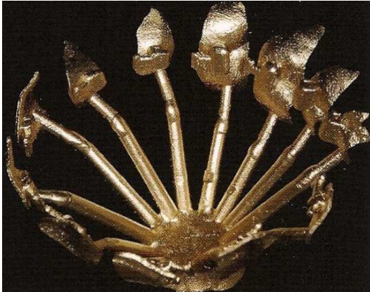
Figure 92 - coulée des brackets personnalisés
