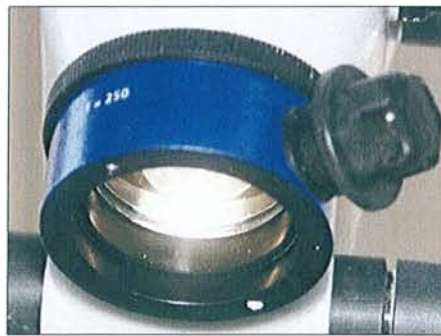
Fig. 15 : molette permettant la mise au point fine (doc. int. EID, 2007).
