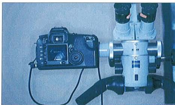
Fig. 26 : appareil photo monté sur bague C.
