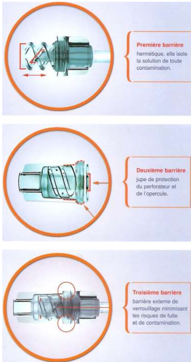
Figure 44 : Connecteur à triple barrière
