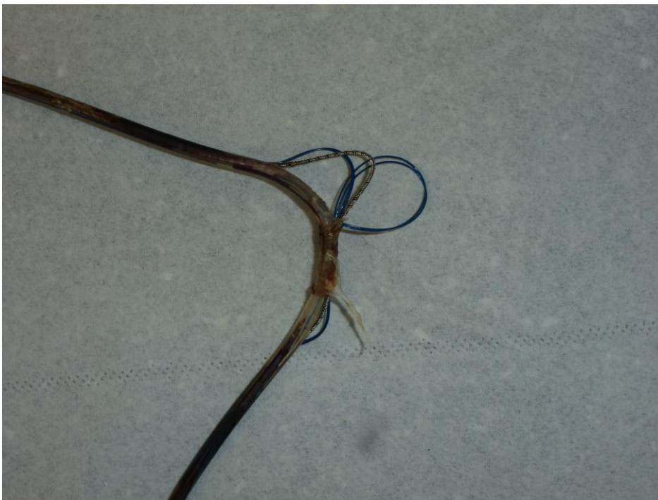
Figure 23 : Extériorisation du conducteur par abrasion de la gaine en silicone
