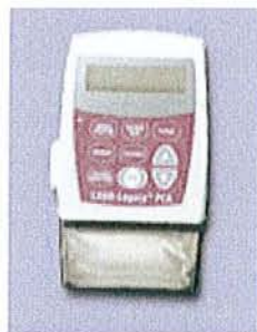
Figure 19 : pompe portable monocanal à débit continu [65]
