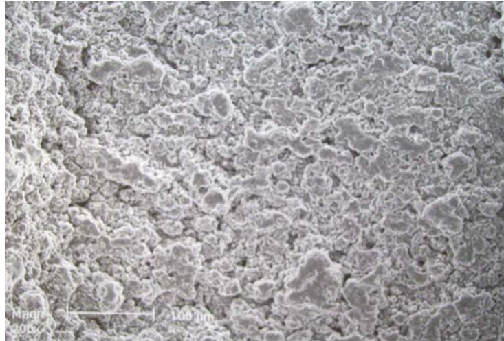
Figure n°6 : Surface obtenue par plasma-spray observée à faible grossissement (x200) (5)
