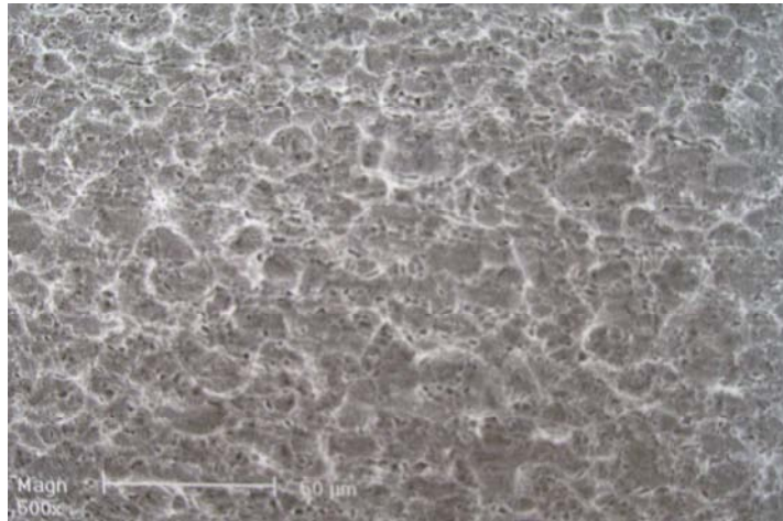
Figure n°12 : Surface obtenue par mordantage du titane observée à faible grossissement (x200) (5)
