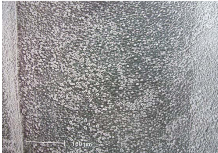
Figure n°8 : Surface obtenue par oxydation anodique observée à faible grossissement (x200) (5)
