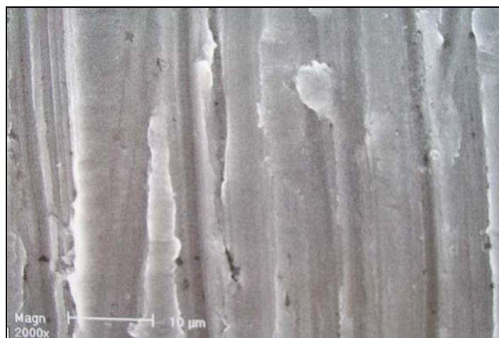
Figure n°5 : Surface usinée observée à fort grossissement (x2000) (5)
