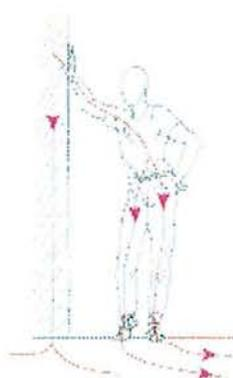
Fig.12 : Foudroiement par tension de toucher
