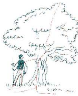
Fig.10 : Foudroiement par éclair latéral
