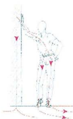
Fig.12 : Foudroiement par tension de toucher
