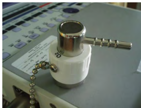
Figures 48 et 49 : Connectique O 2 du LTV 1200 ® adaptable au tuyau plastique de l'Integra 10 ®
