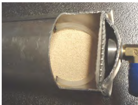
Figure 18 : billes de zéolithe dans la colonne
