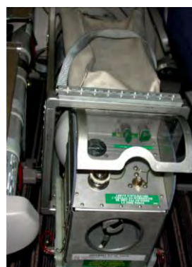
Figure 112 : Débitmètre et robinet sur bouteilles Air France™
