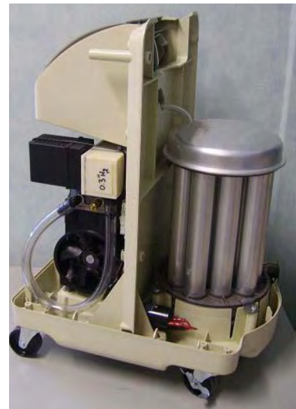
Figure 47 : Module ATF sur Integra10 ®
