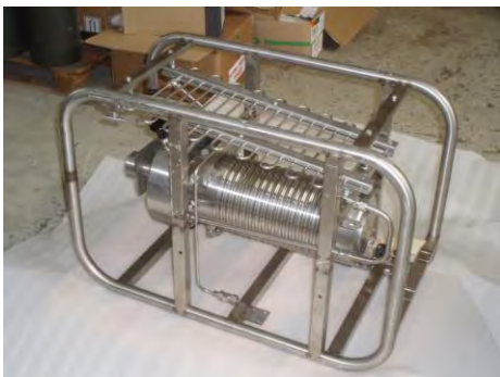
Figure 8 : cadre acier du Soprano 3000®
