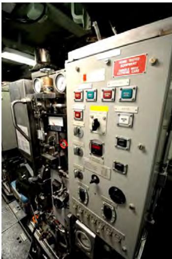
Figure 11 : électrolyseur de sous-marin américain Figure 12 : électrolyseur PIEL™ (d'origine italienne)
