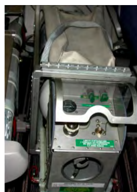
Figure 112 : Débitmètre et robinet sur bouteilles Air France™
