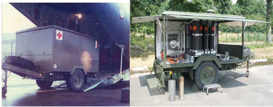
Figures 33 et 34 : Remorque légère de production d'oxygène extraite d'un Transal, puis en cours d'utilisation
