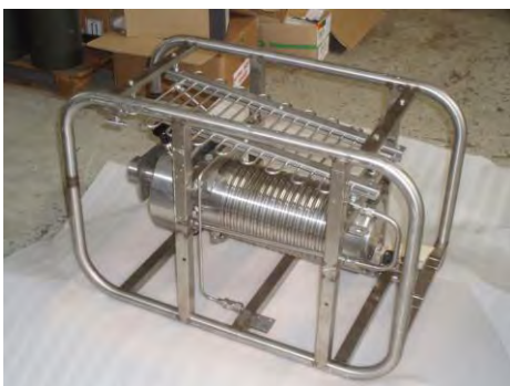
Figure 8 : cadre acier du Soprano 3000®
