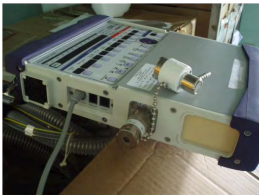
Figures 48 et 49 : Connectique O 2 du LTV 1200 ® adaptable au tuyau plastique de l'Integra 10 ®
