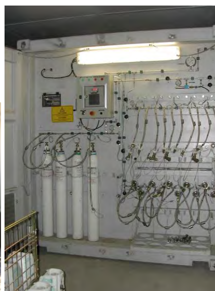
Figures 43 et 44 : Générateur Oxyplus 300 ® (entrée et zone de remplissage des bouteilles)
