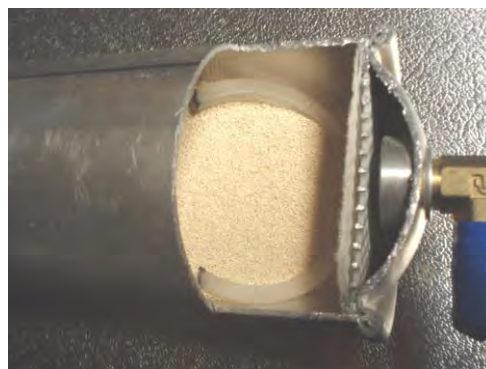
Figure 18 : billes de zéolithe dans la colonne
