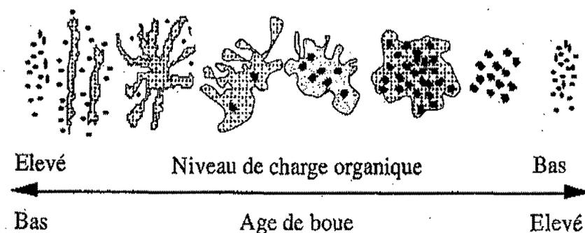
Figure 3.3. Représentation schématique de la morphologie générale des floccs de boues activées en fonction de l'âge des boues (temps de séjour) et de la charge organique des eaux usées (Eriksson *et al.*, 1992).
