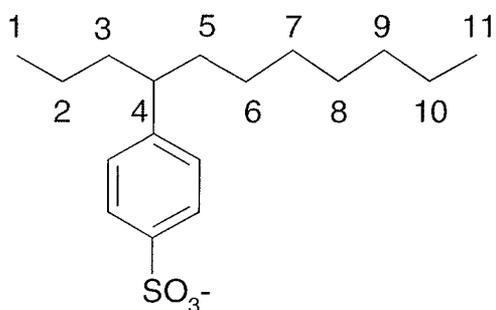
Figure 2.2. Structure chimique d'un sulfonate d'alkylbenzène linéaire, le 4 C<sub>11</sub>-LAS.
