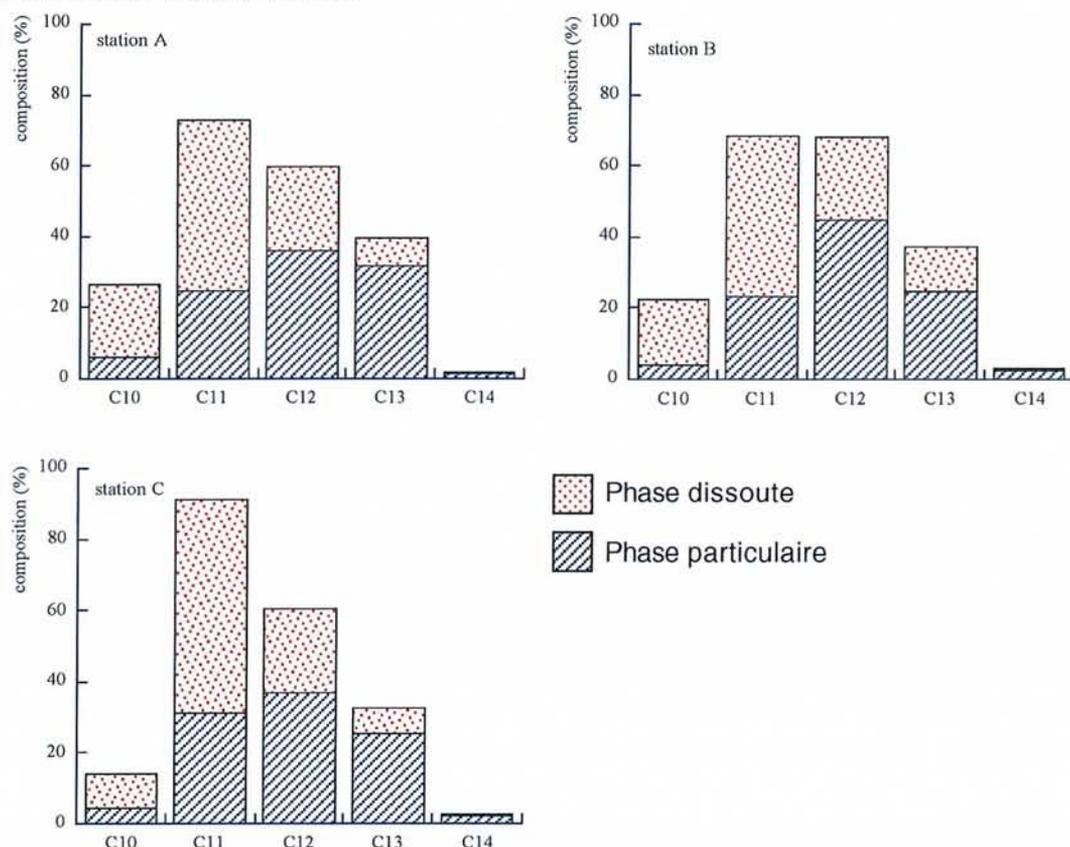
Fig. 4.1. Répartition des différents homologues de LAS dans les phases dissoute et particulaire des eaux usées de trois stations d'épuration différentes (Prats *et al.*, 1993).
