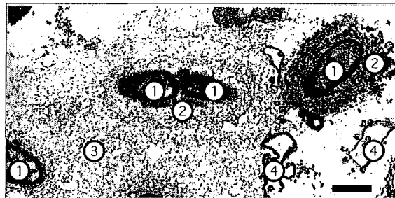
Figure 3.4. Photographie d'une coupe ultrafine de floc de boues activées observé en microscopie électronique après marquage des polysaccharides (Bleich et Nehrkorn, 1989) montrant des bactéries ① entourées de zones d'aspects différents correspondant à des polymères plus ou moins denses ② et ③ ou des lysats cellulaires ④. Barre = 0,5 \mu\text{m} .
