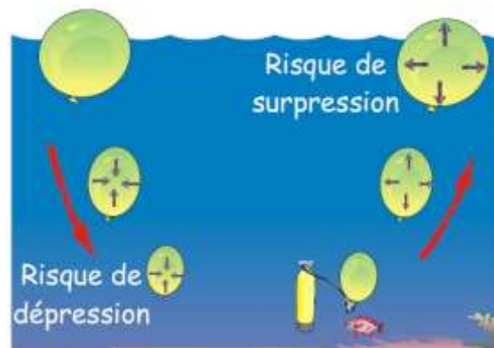
Figure 29: Effet de la pression sur les volumes (Foret, 1999)
