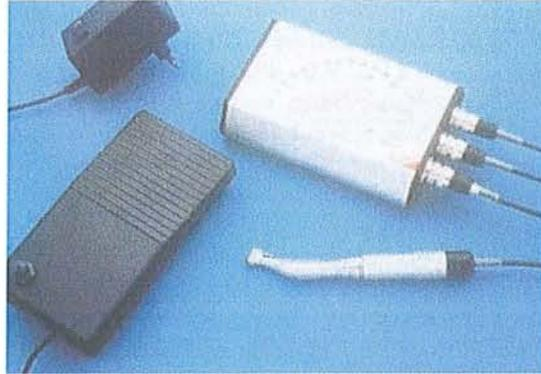
Le moteur dynamométrique « torque controller » de chez Nobel Biocare.
