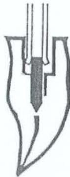
Préhension du trépan avec déformation des dents du trépan.
