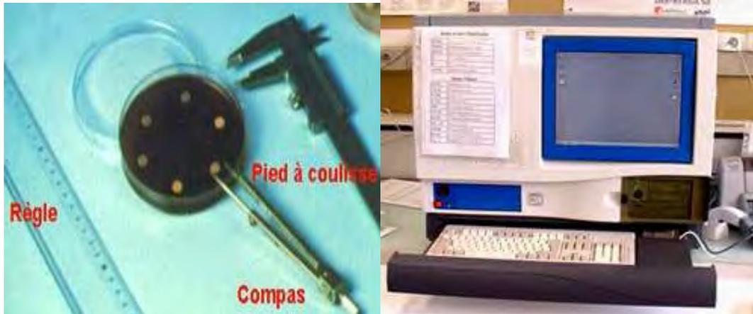
**Figure 7:** Instruments de mesure des diamètres d'inhibition
