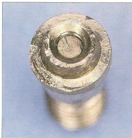
Fig. 39 : Fracture de vis de prothèse à l'intérieur du moignon. (27)
