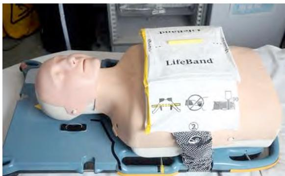
*Figure 4 - Dispositif de MCE par bande constrictive (Autopulse®)*
